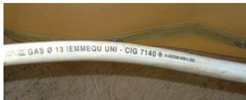
8.20 - Tubo UNI 7140 con data di sostituzione
