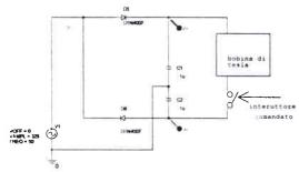
Questa tensione è applicata al condensatore equivalente composto da C1 e C2 che accumula un'energia pari a 0.1 joule.
